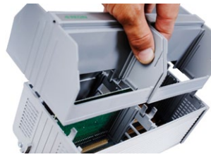
Entfernen der Verkleidung
